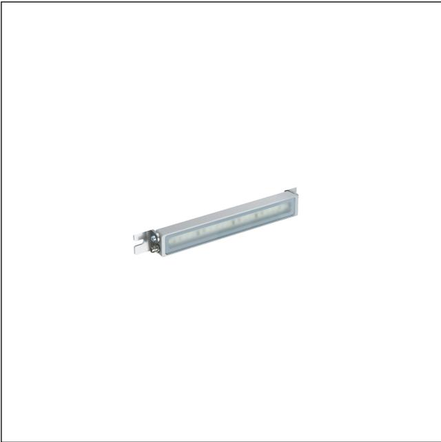
LED-Langleuchte, 4 W, 160 mm Länge, mit massivem Aluminiumgehäuse und diffusem Einscheiben-Sicherheitsglas, IP67, mit M8-Stecker
